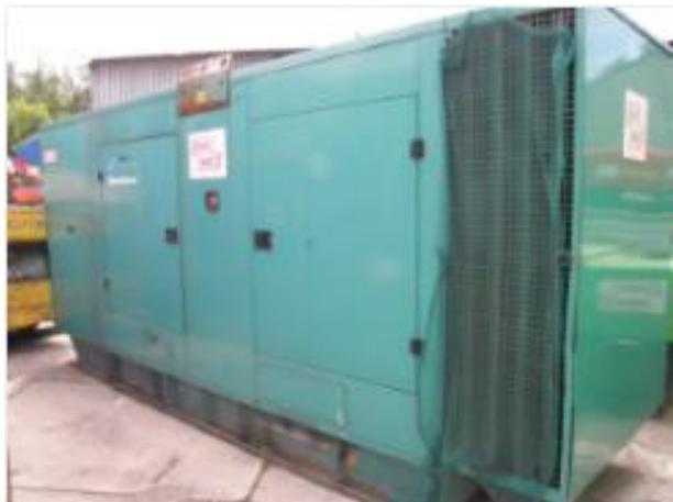
Рисунок 7.17. ДГУ Cummins C350D5S - инв.ОБ0000391
