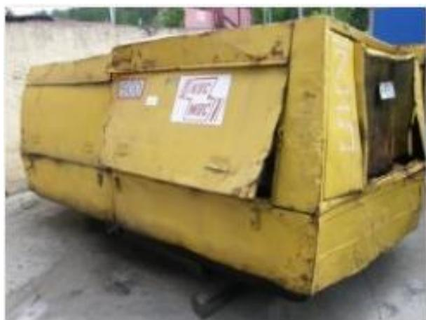
Рисунок 7.27. Компрессорная станция НВ-10-8М2 (4900) - инв.ОБ0000626
