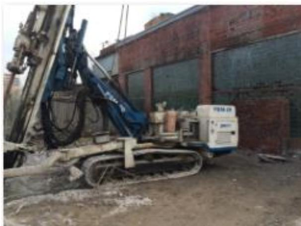
Рисунок 7.11. Бурильная установка PSM (200) - инв.ОБ0000403
