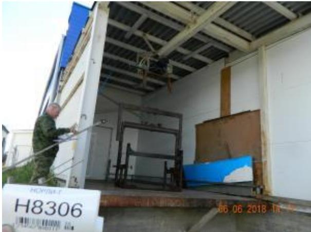
Фото 55 Опрокидыватель отходов
