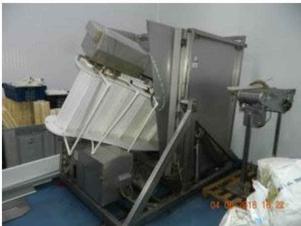
Фото 9 Опрокидыватель для рам гидравлический
