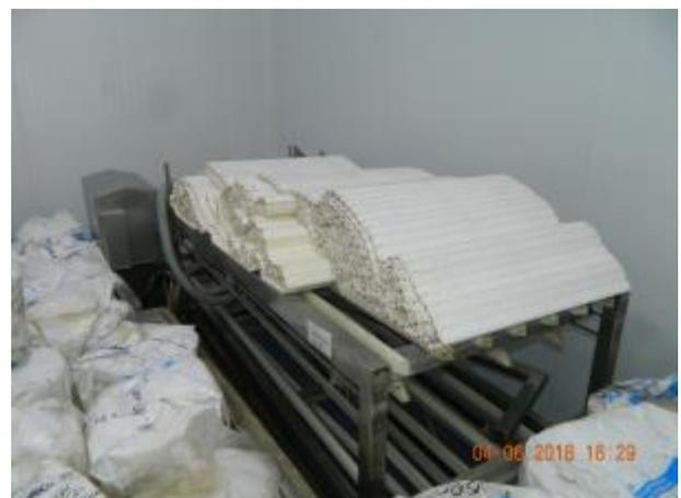
Фото 22. Конвейер раскладки рыбы в тару
