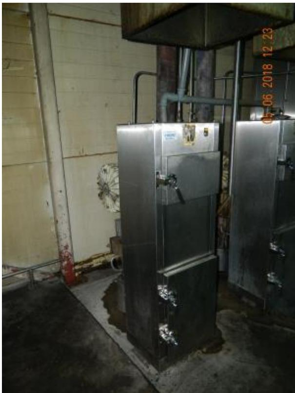
Фото 29 Камера коптильная УКМ 2103\*2 G
