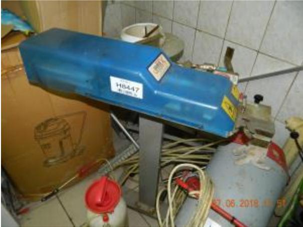
Фото 67 Клипсатор Mini SM 40P с датером тиснения
