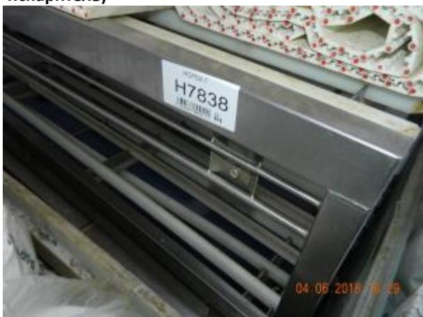
Фото 21 Конвейер раскладки рыбы в тару
