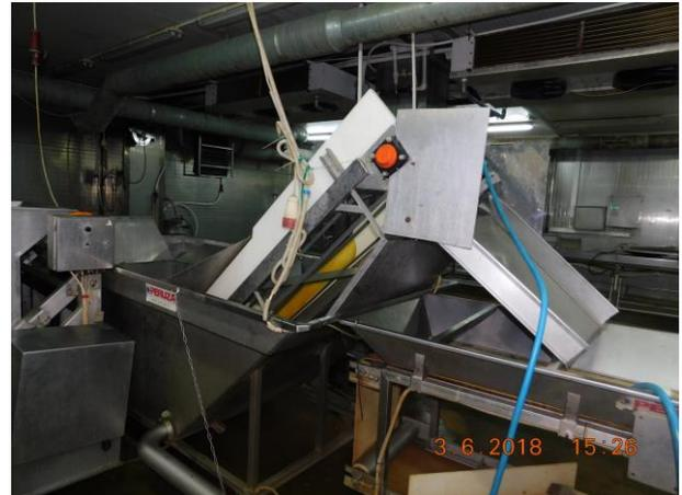
Фото 76 75 Подъемник рыбы с приемной ванной PR-960
