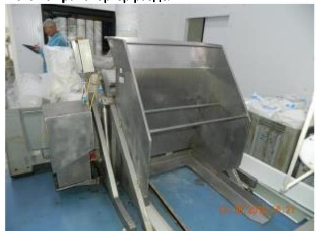
Фото 48 Опрокидыватель контейнеров из нержавеющей стали
