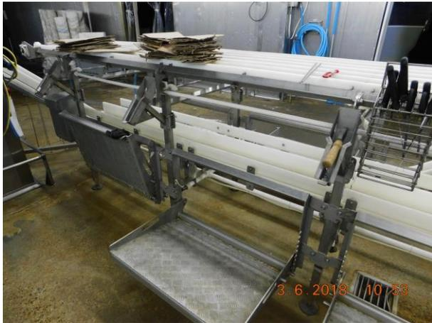
Фото 73 Конвейер разделки и филетирования рыбы на 8 р/м
