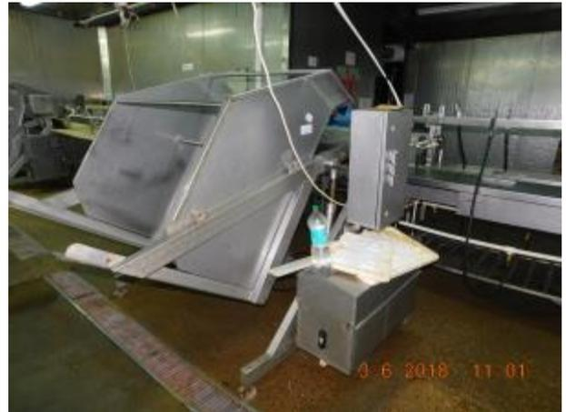
Фото 8. Опрокидыватель контейнеров из нержавеющей стали
