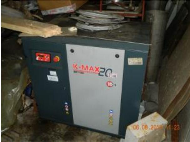
Фото 37 Компрессор винтовой FINI K-MAX
