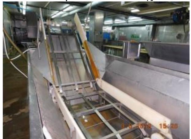
Фото 18. Подъемник рыбы с приемной ванной PR-960
