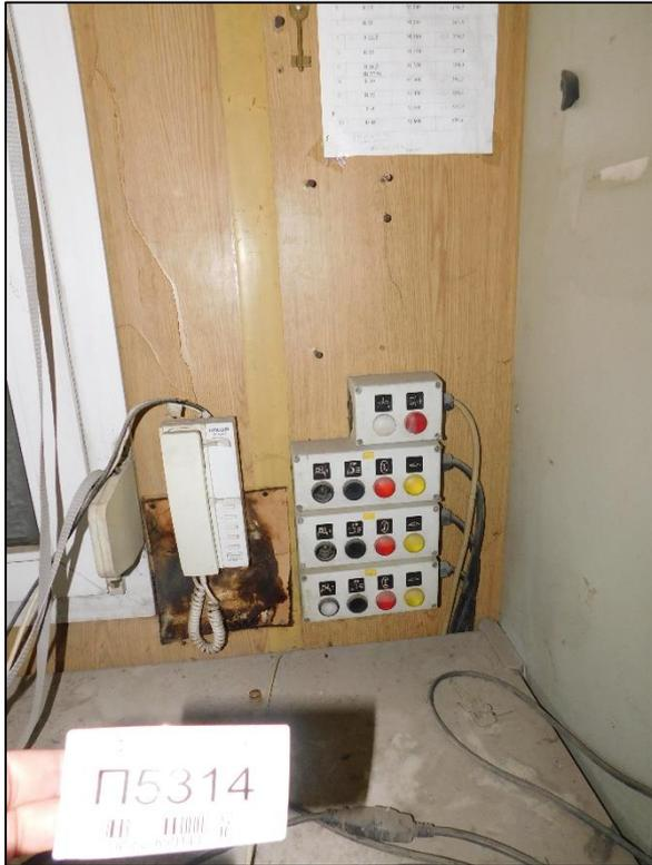
**Фото 151.** Кабина оператора и панель управления, LIEBHERR-MISCHTECHNIK GMSH, тип MOBILMIX
