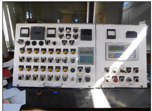
**Фото 135.** Бывшая установка мобильного БСУ Stetter (кабина оператора и панель управления)
