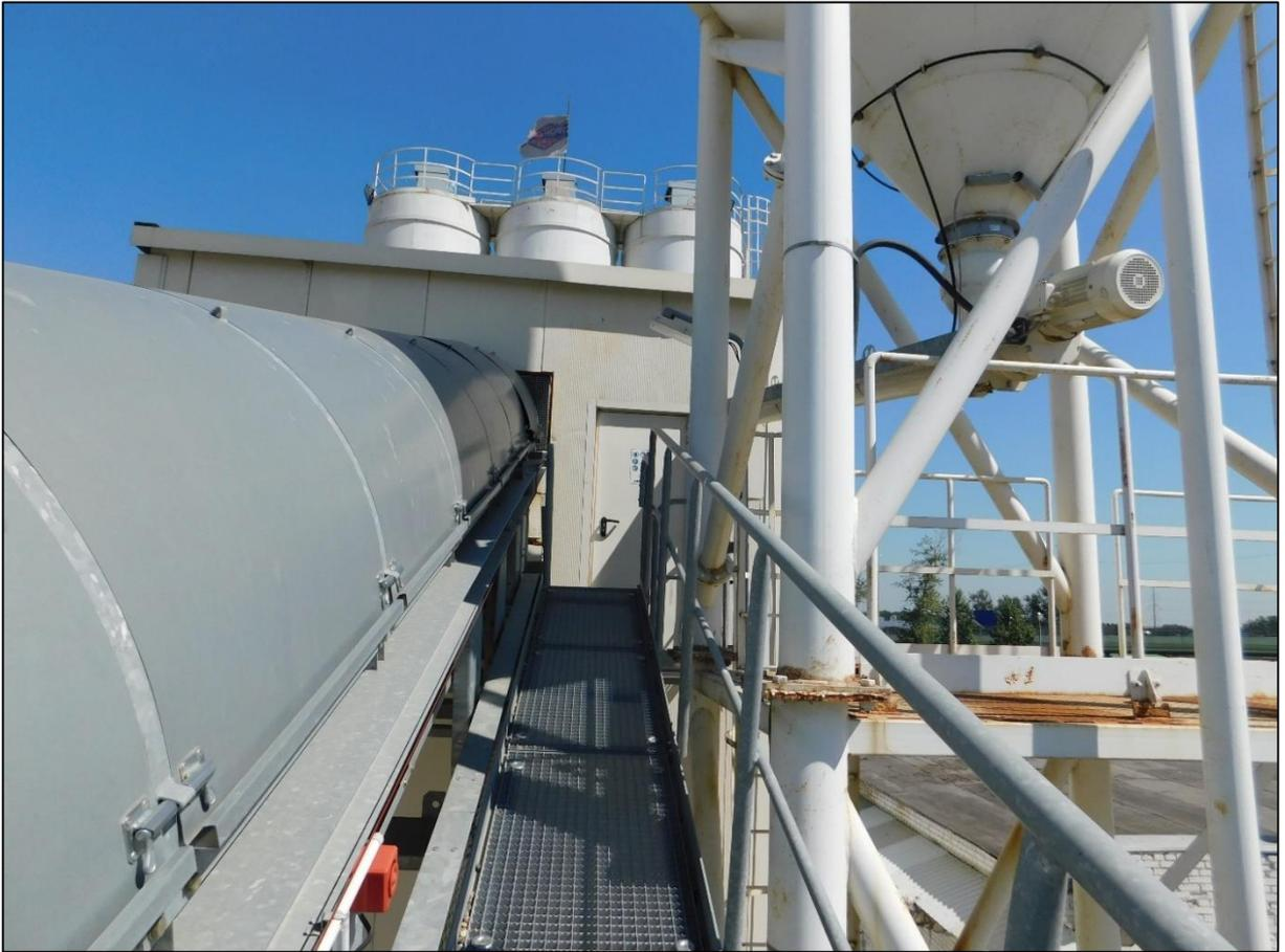
**Фото 17.** Бетоносмесительная установка Liebherr BETOMIX
