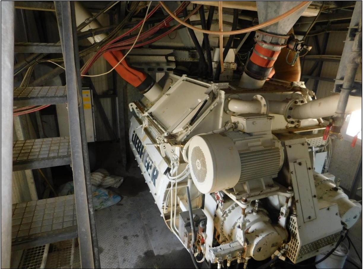
**Фото 14.** Бетономесительная установка Liebherr ВЕТОМІХ
